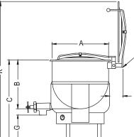
SPRING ASSIST HINGES ON 60, 80 AND 100 GALLON KETTLES
